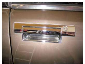
Die Bohrungen für die Gelenkachse Griff-Gehäuse müssen auf 5 mm aufgebohrt werden und die Befestigungslöcher in der Tür müssen 1 ein 2 mm nach unten aufgefeilt werden.
