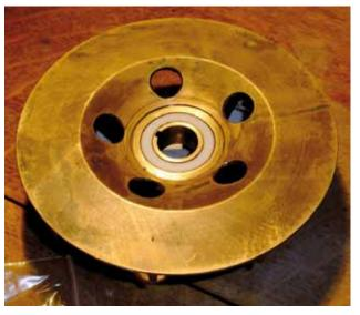
Dieses ergibt, zusammen mit dem 360°-Kontaktring, ein mutmaßlich sehr lang haltendes System. Ich empfehle diesen Weg aber nur mit einer neuen Dichtung zusammen, denn durch den geringen Abrieb der Keramik auf dem Karbon dauert es SEHR lange, bis eine alte, eingelaufene Dichtung wirklich dicht wird.
