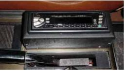
Viele haben sich daher normale Radios mit 180 mm Einbautiefe besorgt und entsprechende Aufsätze für die Mittelkonsole konstruiert und angefertigt.
