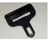
Jetzt ist das Gurtband "nackt" und kann mit der originalen Gurtmechanik bestückt werden. Bei den Chromschnallen erster Serie muss an diesem langen Ende der männliche Chromstecker aufgeschoben werden.
