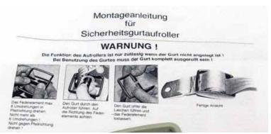
Leider lässt die Qualität der Wickler ein wenig zu wünschen übrig: Wenn man die Achse bei der Installation überdreht, springt die Feder sofort heraus. Man kann die Achse des Wicklers umbauen und verstärken, aber eine Anleitung dafür würde hier zu weit gehen. Man muss halt einfach vorsichtig bei der Installation sein.
