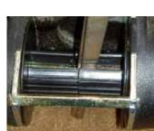
Die Achse steht unter Spannung und ist durch einen langen Gegenstand vor dem Abrollen zu schützen
