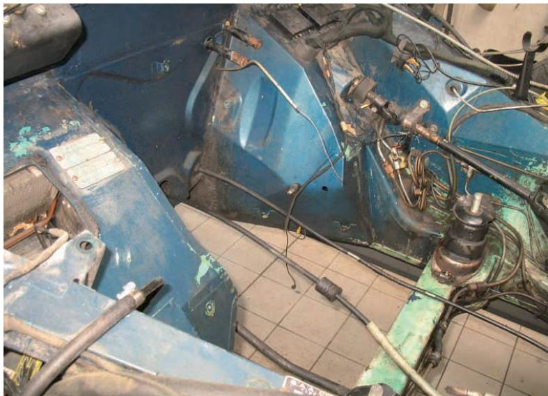
im chicen Brun Scarabee heraus, wo rechts das gleiche Teil noch original grau grundiert vorhanden ist. Die Reparatur wurde aber perfekt ausgeführt. Ansonsten ist vorne alles gerade, keinerlei Verformungen oder Vorschäden erkennbar. Soweit, so gut.
