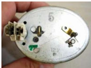
*Ansicht von hinten mit neu gefrästen Löchern wegen der anderen Anschlüsse*
