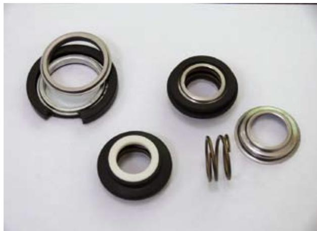
Zwei neugefertigte WaPu Dichtungen, davor eine Feder und ein Trägerblech für dieselben, auch neu. Dahinter eine, zwecks Ermittlung der Abmessungen, aufgeschnittene Getriebedichtung. Da drauf liegt ein neu gefertigtes Trägerblech für die Getriebedichtung
